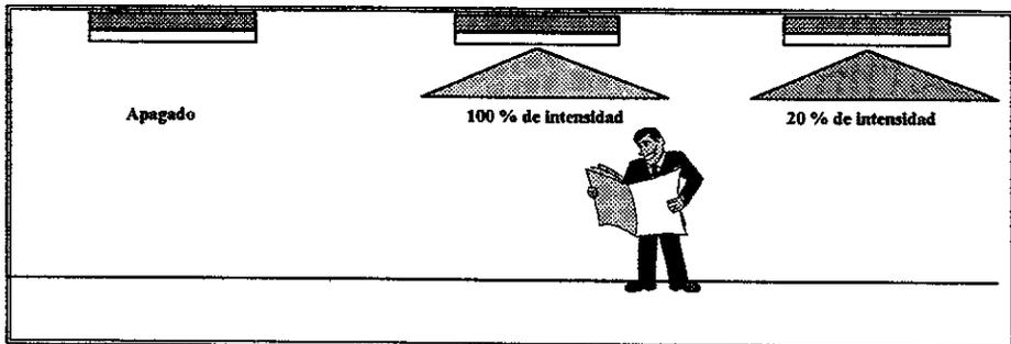
Figura 3.2.. Iluminación en pasillos interiores. El grado de iluminación depende de la presencia o falta de un ser humano en determinado sector del pasillo.
