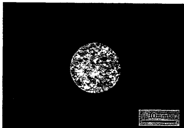
Fig.IV.8.- Probeta macroatacada asociada al experimento 1 de la tabla IV.2, a la que corresponde un tamaño de grano (T.G.) de 517 \mu\text{m} .
