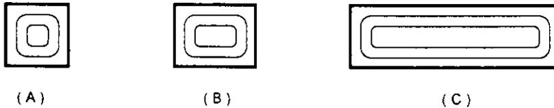
Fig 1.1 Curvas de nivel apoyadas en las losas simplemente apoyadas reforzadas en dos direcciones (a) losa cuadrada, (b) losa rectangular, (c) losa rectangular larga.
