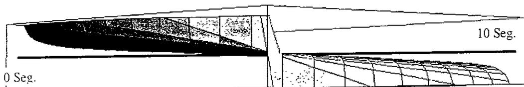
Figura 5.17 Vista lateral de la región geométrica. Se observa como al igual que la trayectoria la región geométrica presenta una simetría muy clara con respecto al tiempo.
