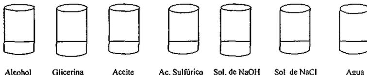
2. Conectar el circuito eléctrico y con cuidado introducir sin que se toquen los extremos de cada cable en cada uno de los vasos de precipitados; enjuagar los cables después de cada ensaye.
