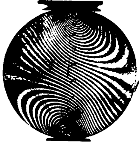
fig. 21 Franjas de moaré en un disco bajo compresión diametral. Las franjas son lugares geométricos de los puntos que tienen el mismo valor de desplazamiento a 45^\circ
