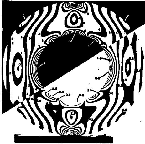
fig. 3.4 Isocromática de un anillo circular sometido a compresión diametral. Espectros en campo claro y en campo oscuro.
