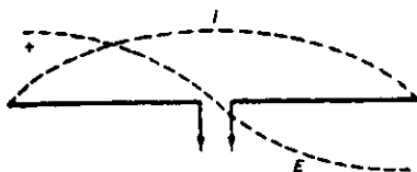
Fig. 2.2 Distribuciones de voltaje y corriente en un dipolo de media onda.
