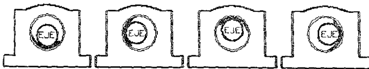
Figura 2 4. Si la excentricidad del eje aumenta, se altera su posición de equilibrio obligando a éste a trasladarse dentro del cojinete, provocando el fenómeno llamado remolino de aceite
