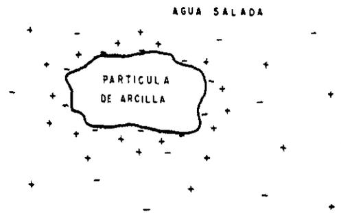
Figura 14. Representación esquemática de la doble capa en un sistema arcilla-agua salada.
