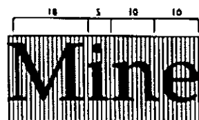
Determinación técnica del sistema de medidas que establece el espacio de cada caracter
