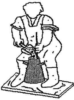
Humedezca el molde y colóquelo sobre una superficie (rígida) lisa, húmeda y no absorbente. El molde deberá estar firmemente colocado en su sitio durante el llenado mientras que el operador apoya sus pies sobre las mensulas de la base.
