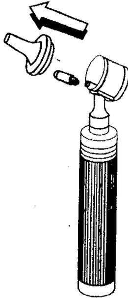
Dibujo 1.1 SE SEPARA EL ESPÉCULO ÓTICO Y SE DESTORNILLA EL FOCO.
