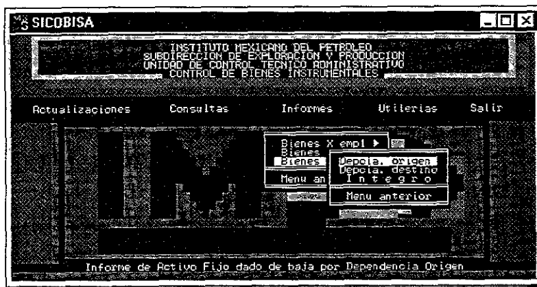
Figura. II 4.2.1 Menú pull-down y anidados. Se permite seleccionar cualquier opción oprimiendo la letra (resaltada) correspondiente a la opción deseada.
