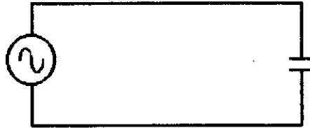
Figura 2.3.7-b Capacitor conectado a un generador.
