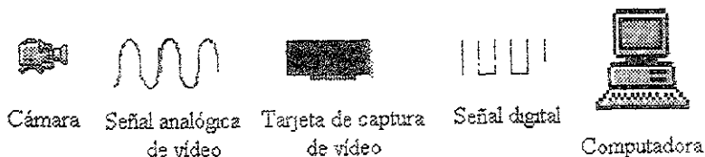
Fig. 3.1 Elementos para la digitalización de una señal de vídeo
