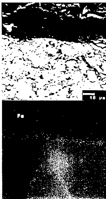
Figura 7.17 Curva de polarización potenciodinámica para el recubrimiento Ni20Cr-Fe17Si a 700°C en 80%V 2 O 5 -20%Na 2 SO 4 , y aspecto en sección transversal del electrodo de trabajo y mapeos de elementos.
