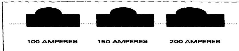
FIG. 3.20 EFECTOS DE LA CORRIENTE ELÉCTRICA.
