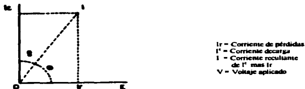
FIG. C. Diagrama vectorial que muestra el comportamiento de un aislamiento al aplicarle un voltaje dado.
