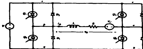
Figura 4.5.0. Convertidor tipo B con conexión en antiparalelo.
