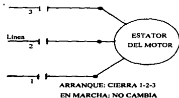
Diagrama 2.1.1. Arranque a plena tensión.
