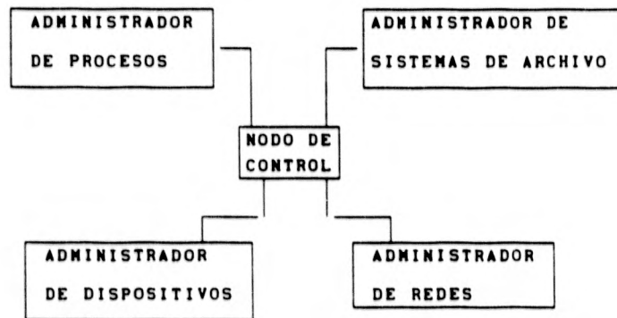
Fig.6.9 Arquitectura del microkernel (microelemento) del Sistema Operativo QNX
