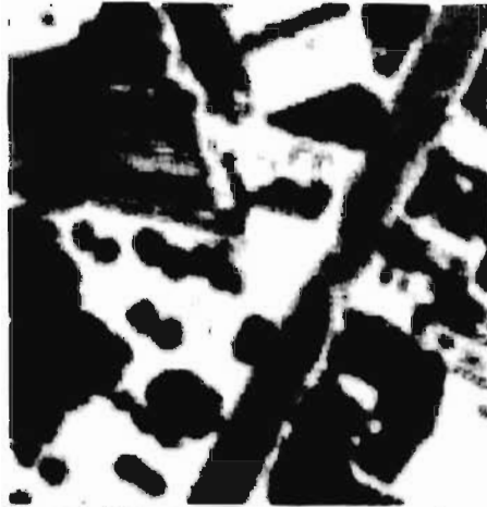
Figura 5.18 Imagen que fue clasificada por distancia de Mahalanobis sometida a un proceso de suavizado. (Tamaño: 128 x 128 1 )
