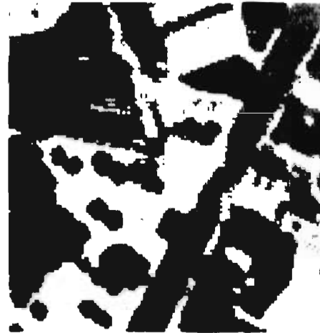
Figura 5.19 Imagen suavizada es nuevamente clasificada utilizando el criterio de umbral. (Tamaño: 128 x 128 1 )
