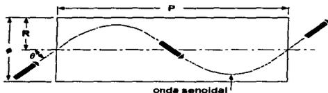
Figura 7.30 Trayectoria de rayo en una lente cilíndrica de índice de gradiente.
