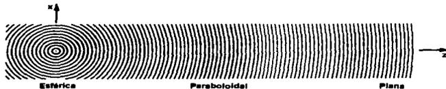
Figura 2.7 Una onda esférica puede ser aproximada por una onda paraboloidal, en puntos cercanos al eje  $z$  y lo suficientemente alejados del origen. Para puntos muy alejados, la onda esférica se aproxima a la onda plana.
