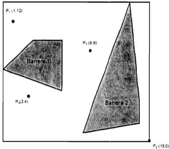
**Fig. 14** Construcción del rectángulo más pequeño (entorno convexo) que incluye a los puntos de demanda y las barreras.
