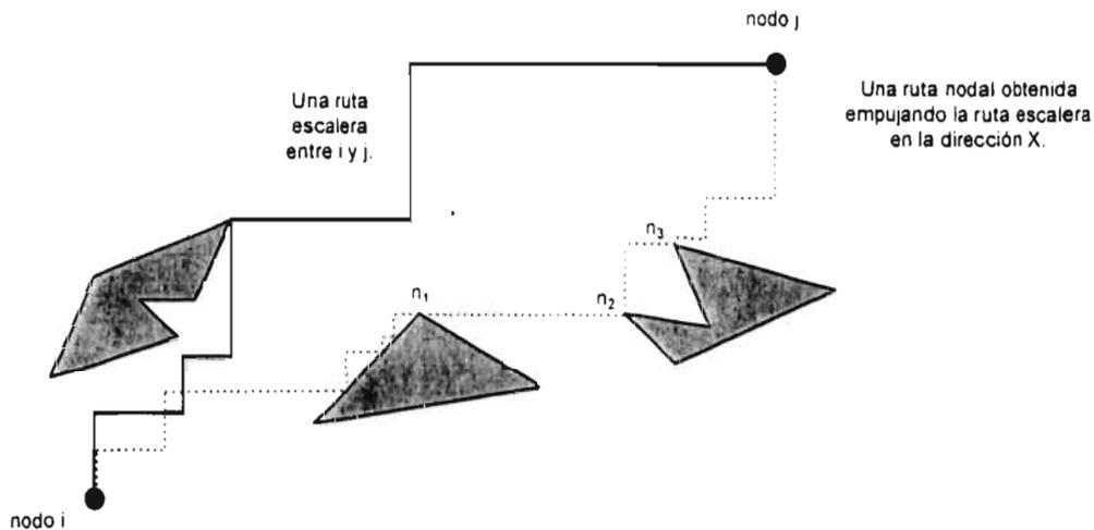
**Fig. 13 Ilustración del proceso de path-push.**
