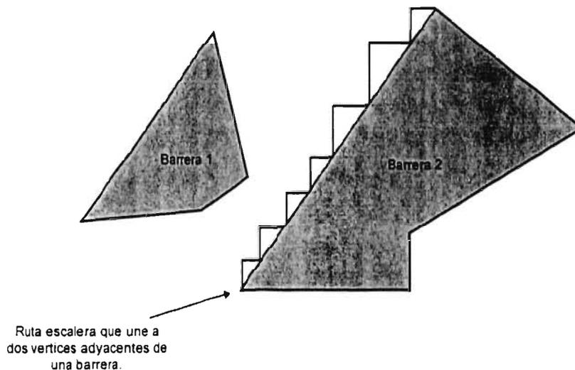
**Fig. 10 Ilustración de una ruta escalera entre dos vértices adyacentes de una barrera.**
