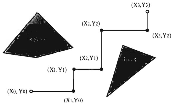
**Fig. 9 Ruta rectangular entre dos puntos en presencia de barreras.**
