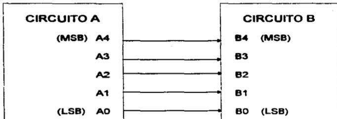
Figura 4.1.2.a Transmisión Paralela
