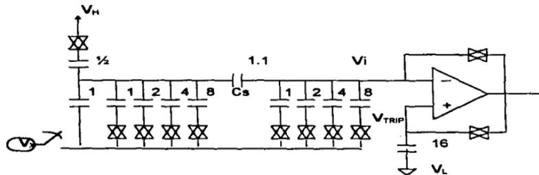
Figura 3.1.6.b Convertidor A/D de aproximaciones sucesivas del MC68HC11.
