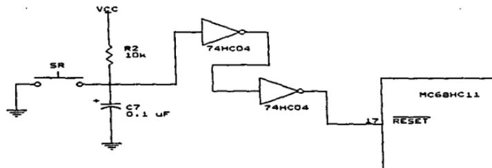
Figura 5.1.1.c Circuito de Reset
