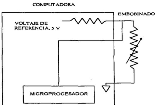
Figura 2.3.2.a Sensor de temperatura (CTS)
