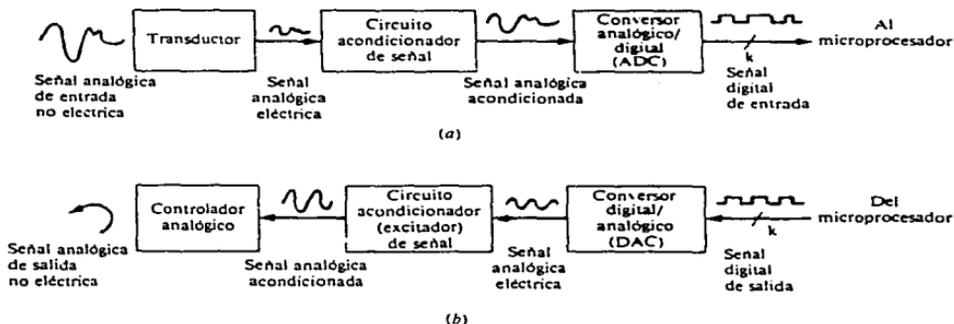
Figura 2.1.2.a Interfaces analógicas de una computadora:
