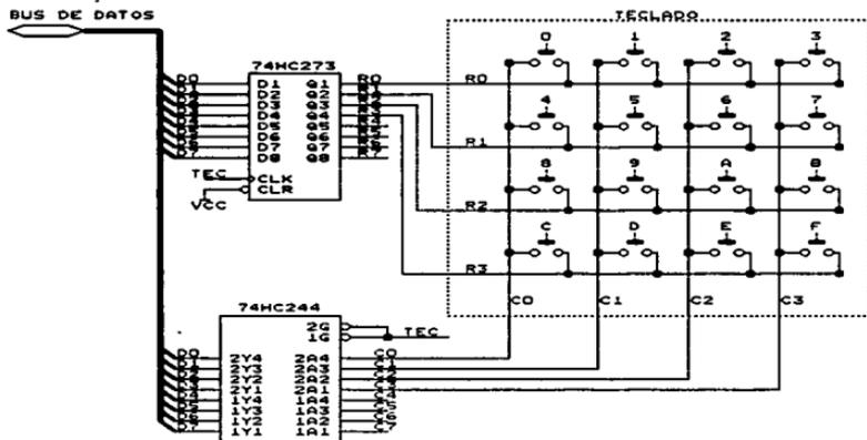
Figura 5.1.1.j Circuito electrónico del teclado del sistema
