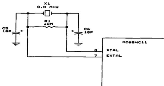
Figura 5.1.1.b Circuito Oscilador
