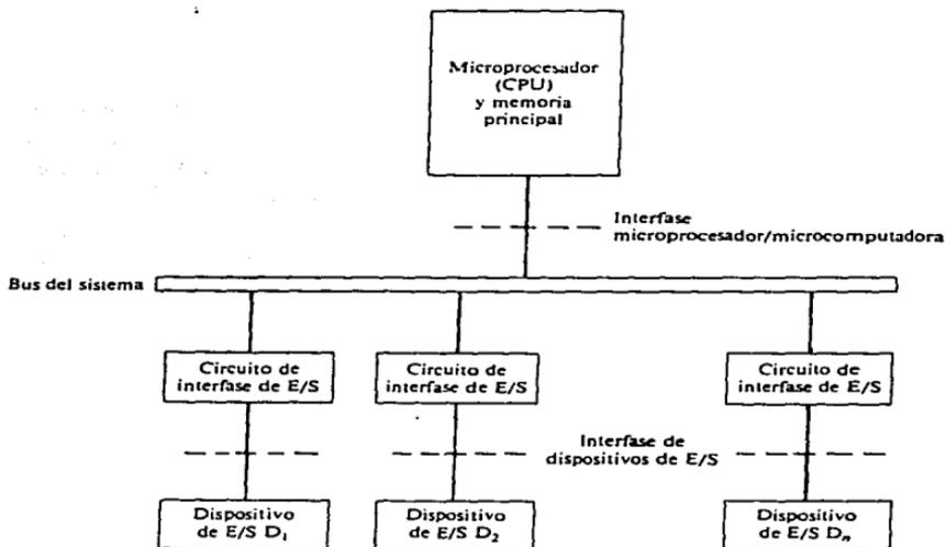
Figura 4.1.1.a Interfaces principales en una microcomputadora
