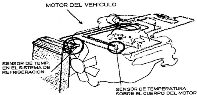
Figura. 2.4.b Montaje del sensor de temperatura en el vehículo.
