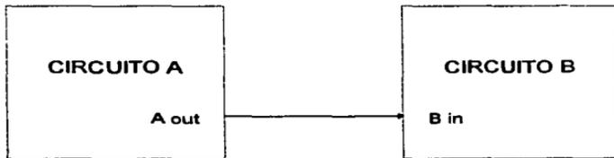
Figura 4.1.2.b Transmisión Serial
