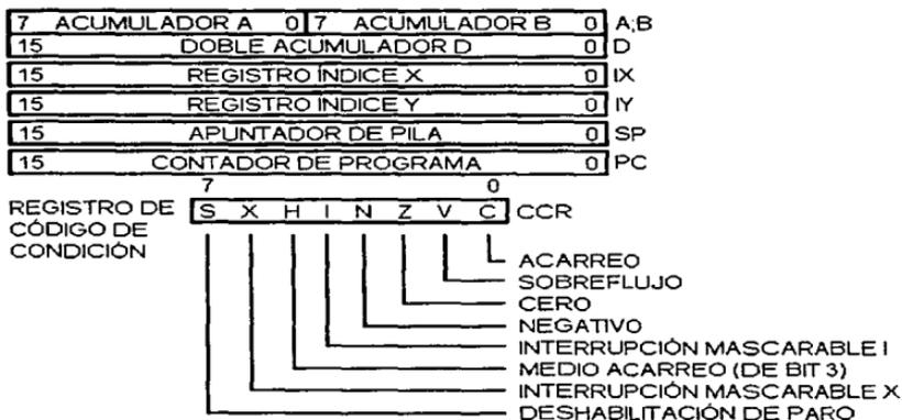
Figura 3.3.a. Modelo de Programación del MC68HC11.
