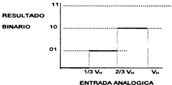
Sin el capacitor de una unidad extra, cada unidad de capacitancia corresponde a una tercera parte del total en vez de la correspondiente cuarta parte. Cuando es agregado el capacitor de 2 unidades, resulta el siguiente circuito con las características de transferencia:
