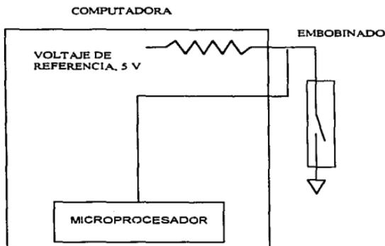
Figura 2.3.2.b Circuito sensor de temperatura del tipo interruptor
