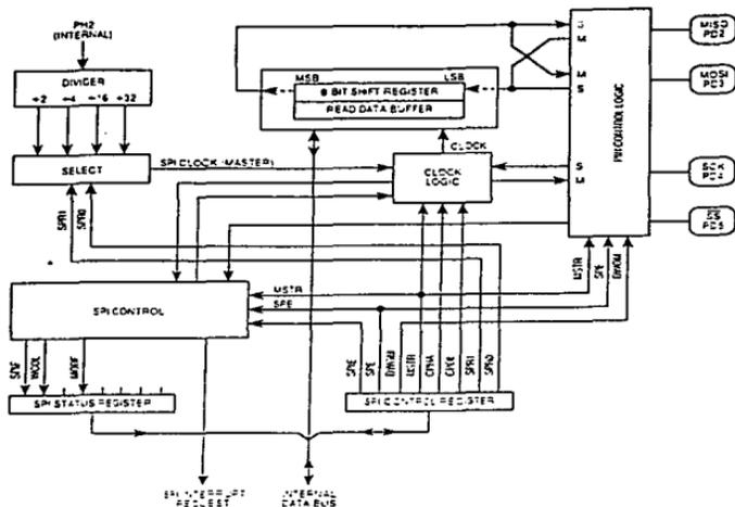
Figura 3.1.4 Diagrama de bloques del subsistema de interfaz periférica serial síncrona
