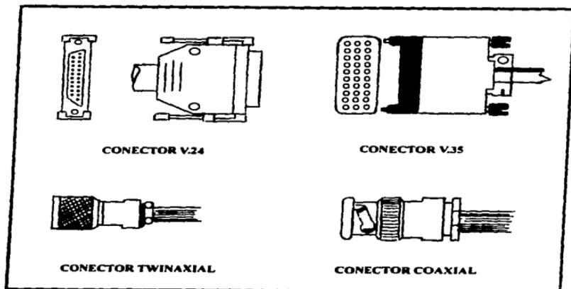
Figura 4.1.3.1.a Diferentes tipos de conectores
