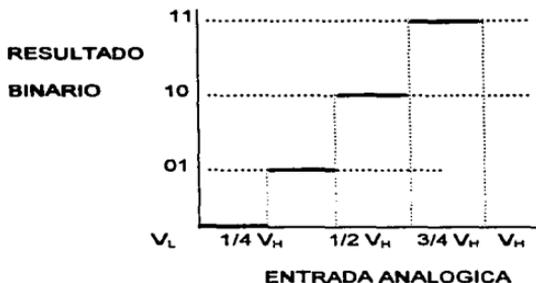
Una entrada analógica de  $1/4$  de  $V_H$  produce un resultado digital de 01<sub>2</sub> o  $1/4 V_H$ , pero una entrada analógica de  $1/8$  de  $V_H$  produce un resultado digital de 00<sub>2</sub> o  $0.0 V_H$ , lo cual equivale a un error de  $1/8$  de  $V_H$  o  $1/2$  LSB.
