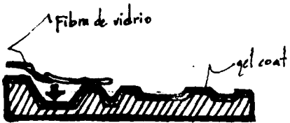
COLOCACION DE FIBRA DE VIDRIO
