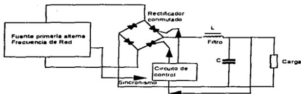
Figura A.2.2 Organización de un regulador conmutado a la frecuencia de la red, que efectúa simultáneamente la rectificación.
