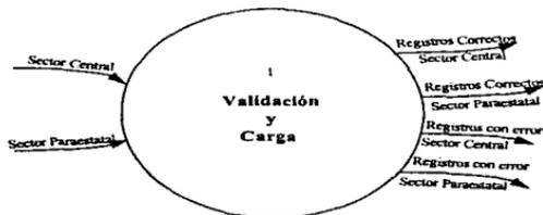
Fig. I.1.4a Diagrama de flujo de datos para la validación y carga de información del sistema de regionalización primer nivel.
