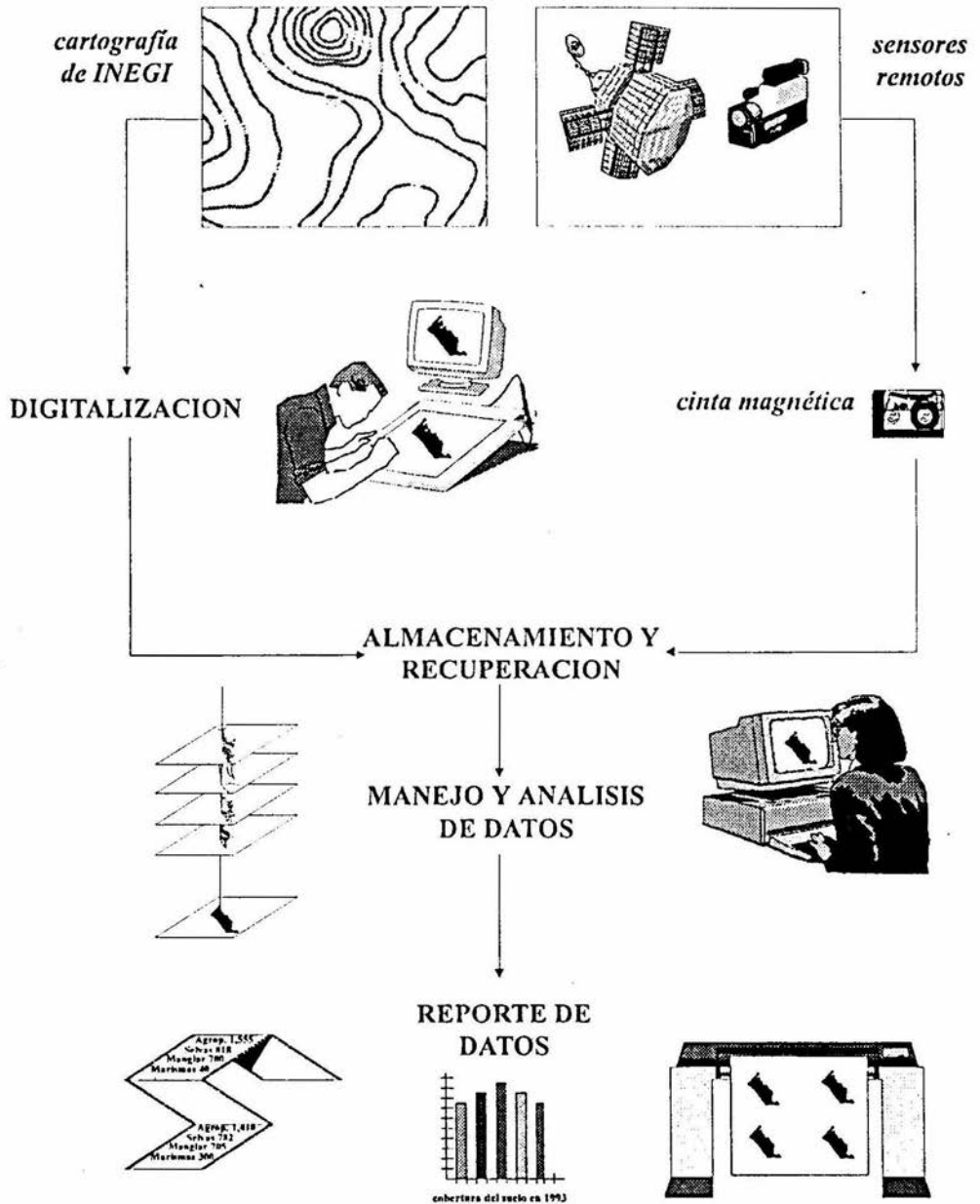
Figura 1. Estructura de un sistema de información geográfica y procesamiento de la información espacial.
