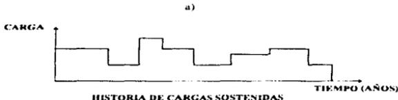
Fig. II.1 Representación esquemática de las cargas vivas.
