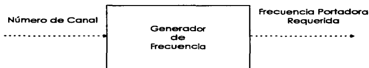
Figura 2.19 Generador de Frecuencia, Descripción simplificada
