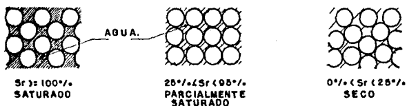
FIG. 4.3.- GRADO DE SATURACION DEL SUELO.
