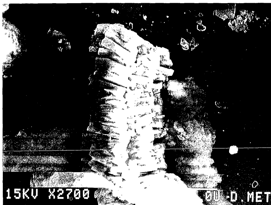
Figura 4.5. Micrografía MEB de paquetes de caolinita junto a agregados globulares de ópalo-c.
