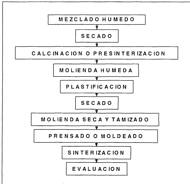
Fig. 4.1.- Diagrama del proceso típico de fabricación cerámica. [4]
