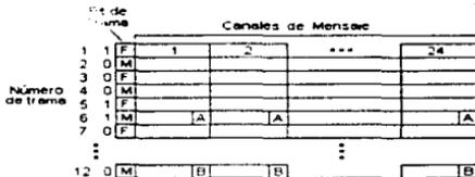
Multitrama de 12 tramas con señalización por robo de bit.
