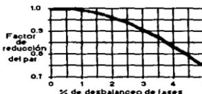
Figura 6.4. Factor de reducción del par del motor por desbalanceos del voltaje de alimentación
