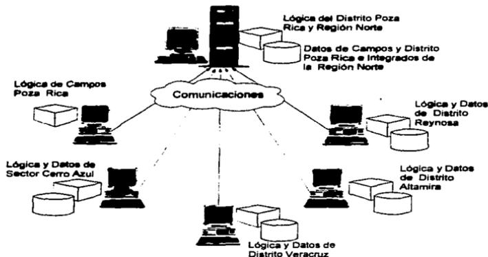
*Fig. 7.5 Diagrama Cliente/Servidor de la Región Norte*
