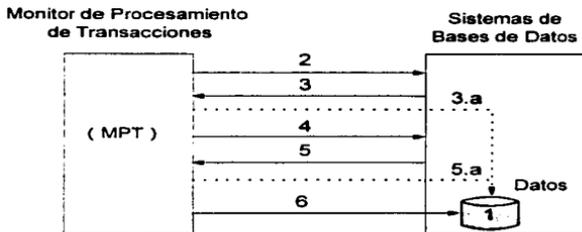
Fig. 2.1. Monitoreo de procesamiento de transacciones. (1)Estado actual de los datos, (2)Precompromiso, (3)Preparados, (4)Realizar actualizaciones, (5)Actualizaciones terminadas, (6)Se completa la transacción, (3.a) y (5.a) Abortar transacción.
