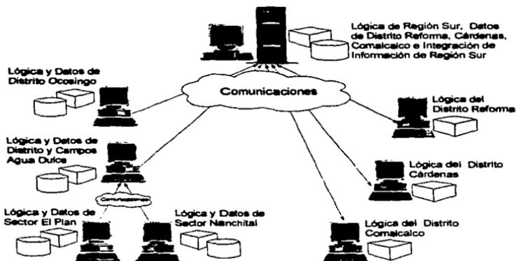
Fig. 7.6 Diagrama Cliente/Servidor de la Región Sur
