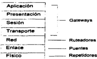
*Figura 3.6. Relación de los dispositivos de red con el modelo OSI.*
