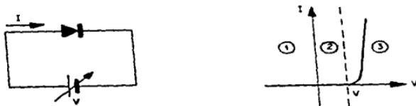
Fig. 1.5.21 Característica tensión-corriente de un diodo.
