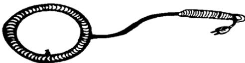
Fig. III.7.1 Bobina Desmagnetizadora.
