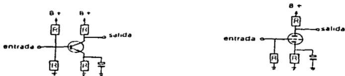
Fig. 1.12.1 Configuración Emisor Común.
