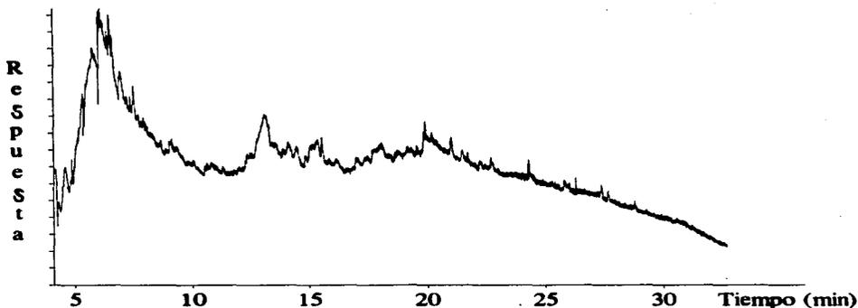
**Figura 3.14.** Cromatograma de gases de los tholins obtenidos por acción de 2 horas de descarga de tipo corona sobre una atmósfera simulada de Titán (88% N<sub>2</sub>, 10% CH<sub>4</sub> y 2% Ar) a 500 Torr y 25°C.
