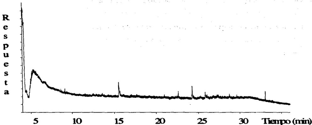
**Figura 3.16.** Cromatograma de gases de los tholins obtenidos por acción de 3 horas veinte minutos de descarga tipo corona sobre una atmósfera simulada de Titán (88% N<sub>2</sub>, 10% CH<sub>4</sub> y 2% Ar) a 500 Torr y 25°C.
