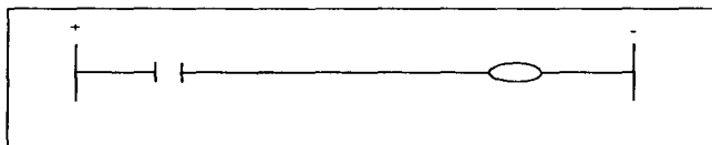
Fig. 5.3 La forma conceptual más simple de representar un diagrama de escalera.
