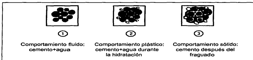
fig. 3.1. Proceso de fraguado de una lechada.
