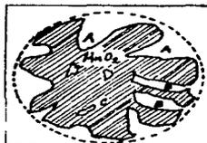
Superficie superficial : (—) , Superficie debido a la inclusión de las paredes del poro : (— —)
