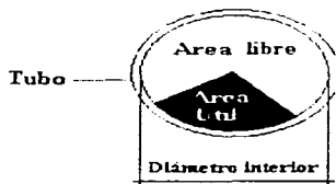
Figura 2.6. Representación de área útil y libre de un tubo.
