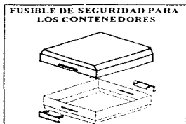
Fig. IV.5. Fusibles de seguridad para los contenedores.
