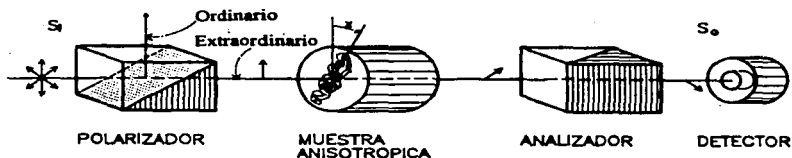
Figura 1.1. Esquema de un sistema de polarizadores cruzados. La flechas que aparecen sobre el eje óptico muestran la dirección de polarización del haz de luz, mientras que x representa el ángulo de orientación de la birrefringencia.
