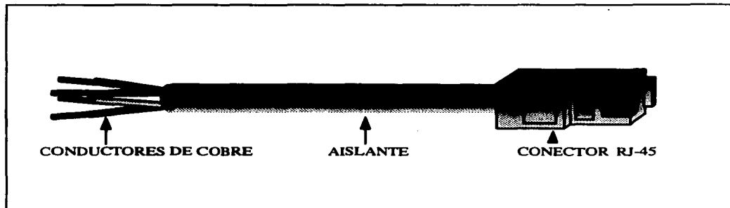
Figura 4.6 Cable Par Trenzado.
