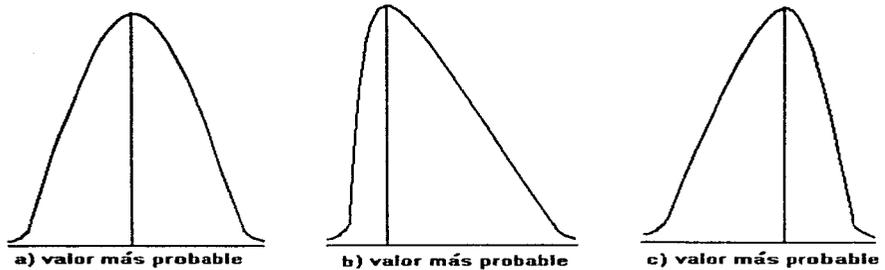
**FIGURA 5.14** Curva en forma de campana y curvas de distribución beta. a) Curva normal en forma de campana. b) y c), curvas de distribución beta, o asimétricas en una dirección.
