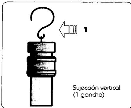
De forma cilíndrica de  $\varnothing 5.5$  cm y 56 cm de largo.
