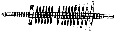
ROTOR DE TV DE VARIOS ESCALONAMIENTOS
