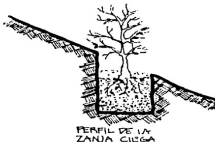
Se abre una zanja y se vuelve a llenar, siguiendo el trazo de la curva de nivel y dejando entre zanja y zanja una interrupción de 50 cms. de ancho.
