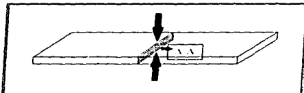
Sección transversal requerida
