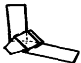
DETALLE B UNION DE TRABES POR MEDIO DE UNA PLACA
